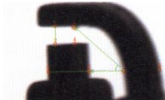
FIG. 1.9 – Mesure sur une bougie de moteur thermique par rétro-éclairage
