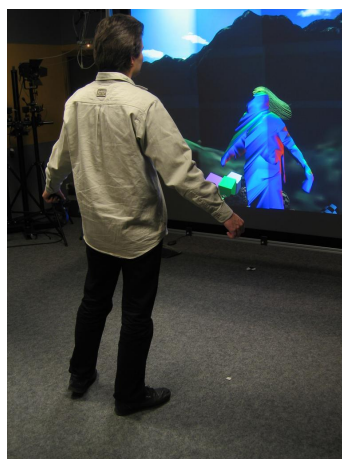
Figure 7.3 Perruque virtuelle : interactions entre l'utilisateur et une simulation de cheveux grâce à l'ajout de l'information d'identification de la tête.
