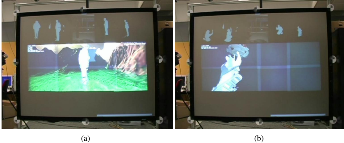
Figure 7.4 Sculpture virtuelle grâce à la modélisation volumique sous forme d’octree : l’utilisateur peut ajouter, supprimer de la matière ou changer sa couleur.
