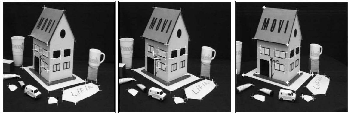
FIG. 9 – Trois images d’une maison. Sont montrés par des croix les points image utilisés pour la reconstruction 3D. La base de la reconstruction projective initiale est attachée aux cinq points marqués par des disques blancs dans l’image 3.
