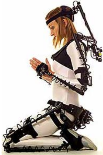
FIG. 2.1: Système prothétique de capture du mouvement (société Gypsy).
