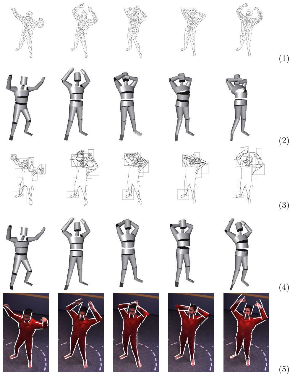
FIG. 6.18: Suivi du mouvement comparé entre la méthode utilisant les contours extraits à l'aide d'un détecteur standard de Canny et la méthode utilisant les contours extraits avec le filtre anisotropique gaussien. La méthode de détection de contours standard est illustrée sur la ligne (1). La pose estimée à l'aide de cette méthode est illustrée sur la ligne (2). Le suivi du mouvement échoue : les bras ne sont pas correctement estimés. Le filtrage anisotropique gaussien (ligne (3)) permet de suivre correctement le mouvement humain. Les résultats sont donnés sur la ligne (4). Enfin, la dernière ligne est la projection du modèle 3D sur les images.
