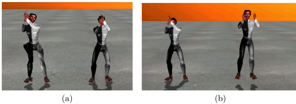
FIG. 6.20: (a) - A gauche, le mouvement que nous estimons est appliqué à un avatar, tandis qu'à droite le mouvement est corrigé à l'aide de l'application MKM. Nous pouvons voir qu'au niveau des mains, le contact n'est pas correct sur l'estimation et est corrigé. De plus la cuisse est mal orientée et est donc corrigée. (b) - Nous comparons le résultat de SEMOCAP avec celui donné par VICON. Nous pouvons voir que les mains ne se touchent pas avec les résultats VICON.
