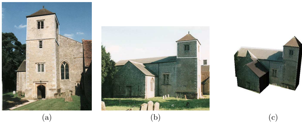
Figure 9: l'Eglise de Chetwode. Reconstruction à partir de 2 images en provenance d'Internet; (a), (b) Des images originales (remerciements à M. Kevin Quick); (c) Le modèle reconstruit.
