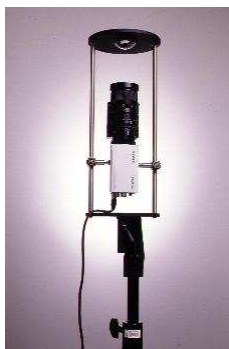
FIG. 8: Un capteur omnidirectionnel, consistant d'une caméra et d'un miroir parabolique.
