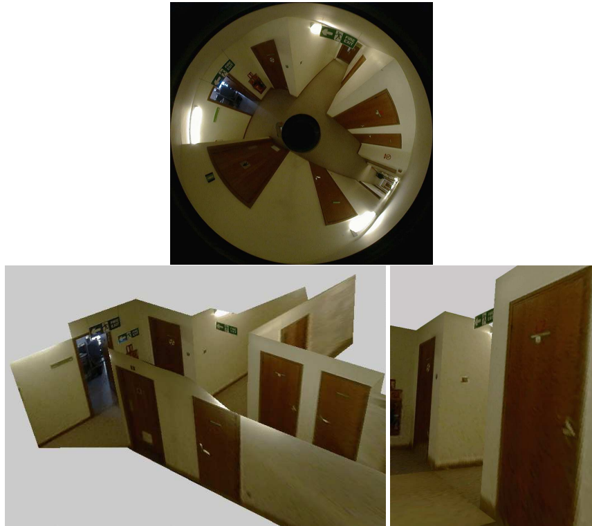
FIG. 9: Une image omnidirectionnelle et deux rendus du modèle 3-D construit à partir de cette image.
