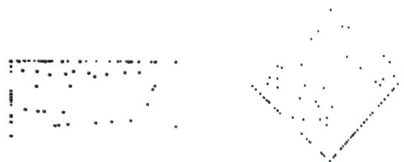
FIG. 5: Optimisation de la position des points par minimisation contrainte de l'erreur de reprojection. Les relations de multi-coplanarité sont parfaitement satisfaites.
