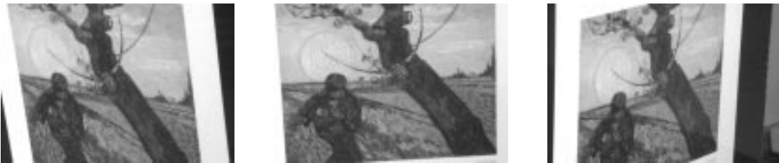
FIG. 2.16 – À gauche l'image 0 de la séquence pour un changement complexe de luminosité, au milieu l'image 7 et à droite l'image 15. L'image 0 est prise pour la position de la caméra la plus à droite. Pour l'image 7 la caméra est positionnée en face du tableau. En ce qui concerne l'image 15, c'est la prise de vue la plus à gauche.
