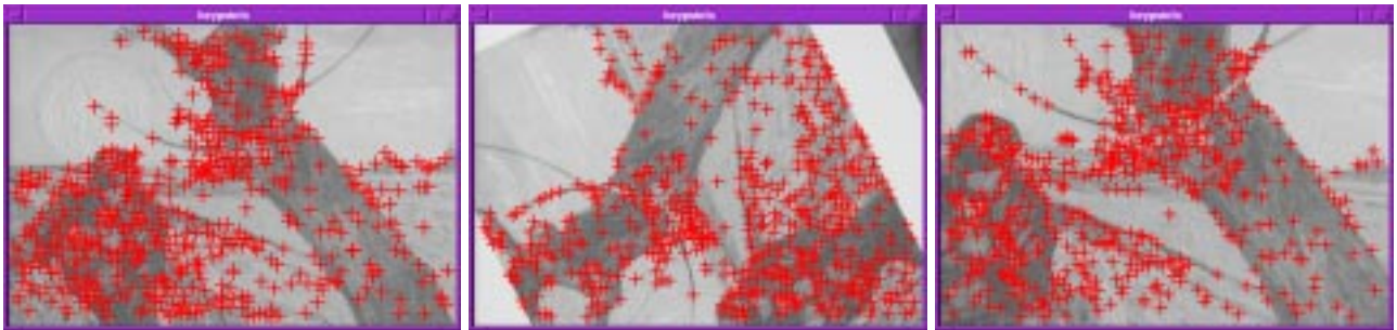
FIG. 2.6 – Points d’intérêt détectés sur la même scène pour différentes transformations de la caméra. La rotation entre l’image de gauche et l’image du milieu est de 155 degrés. Le facteur d’échelle entre l’image de gauche et l’image de droite est de 1.4.
