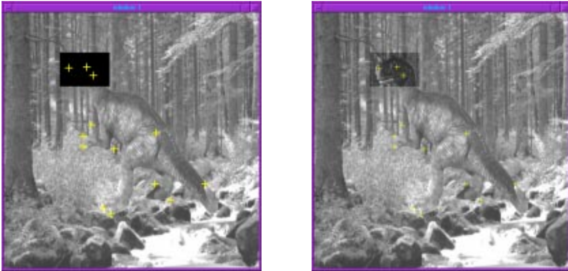
FIG. 6.14 – Exemple de récupération de données symboliques en présence d'occultations. L'image de gauche est l'image utilisée pour la recherche sur laquelle sont positionnées les données retrouvées. L'image de droite dévoile l'occultation et montre la précision des résultats obtenus.
