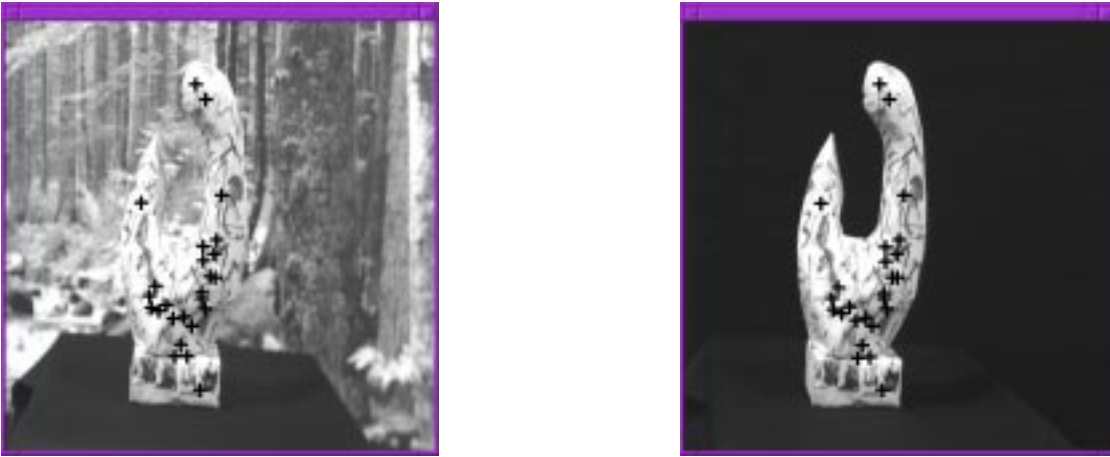
FIG. 6.8 – Illustration des points appariés lors du processus de reconnaissance. L'image de droite a été correctement reconnu à partir de l'image de gauche.
